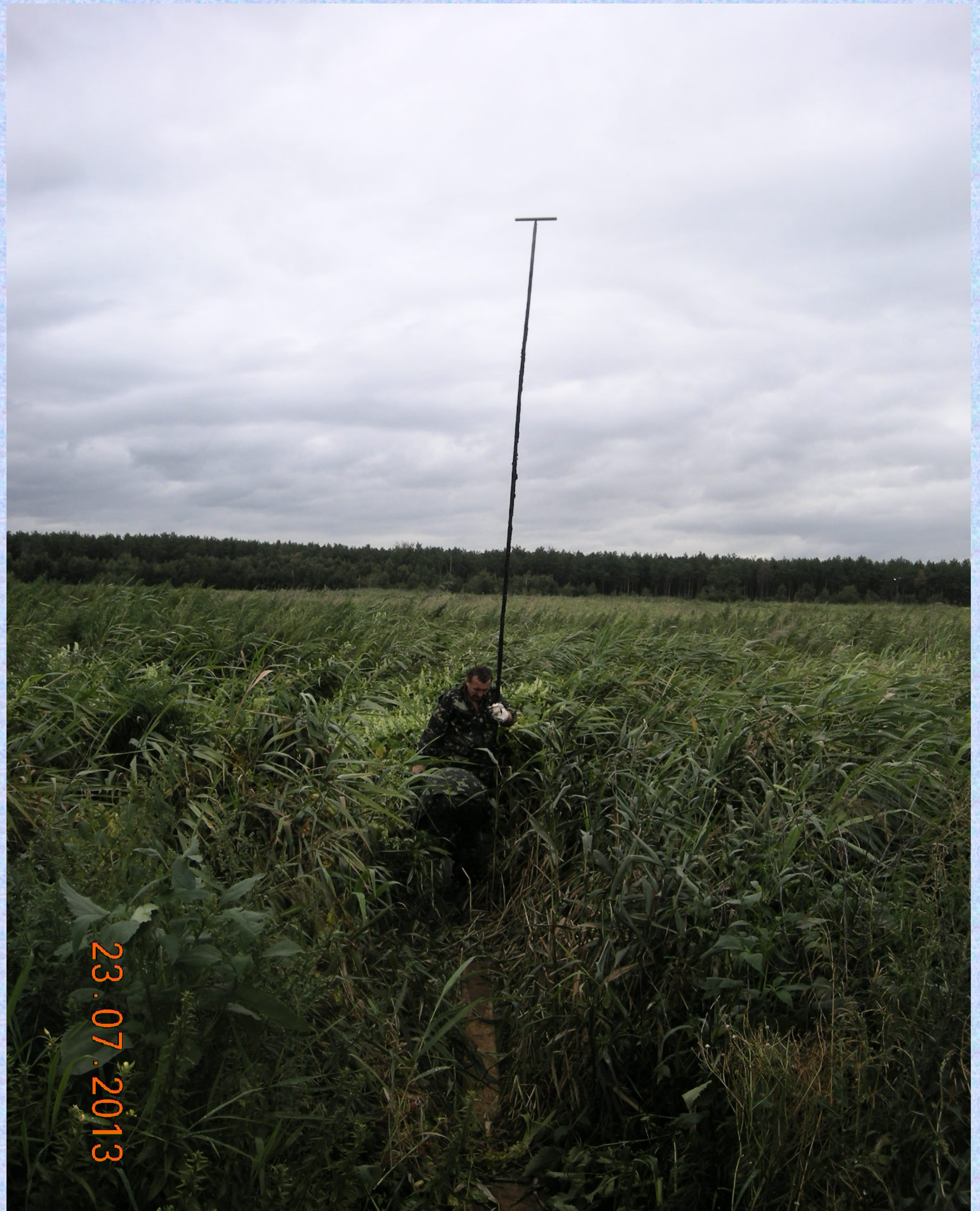
Відбір проб мулу із свердловини ручного буріння на муловому полі № 1 (глибина 4,8 м)
