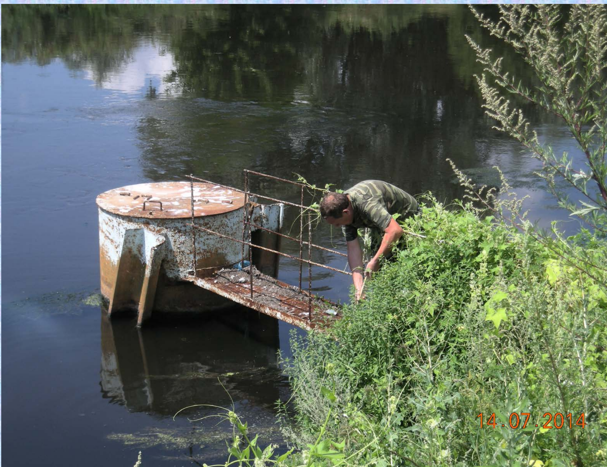
Відбір проб донних відкладів із водовідвідного каналу БСА
