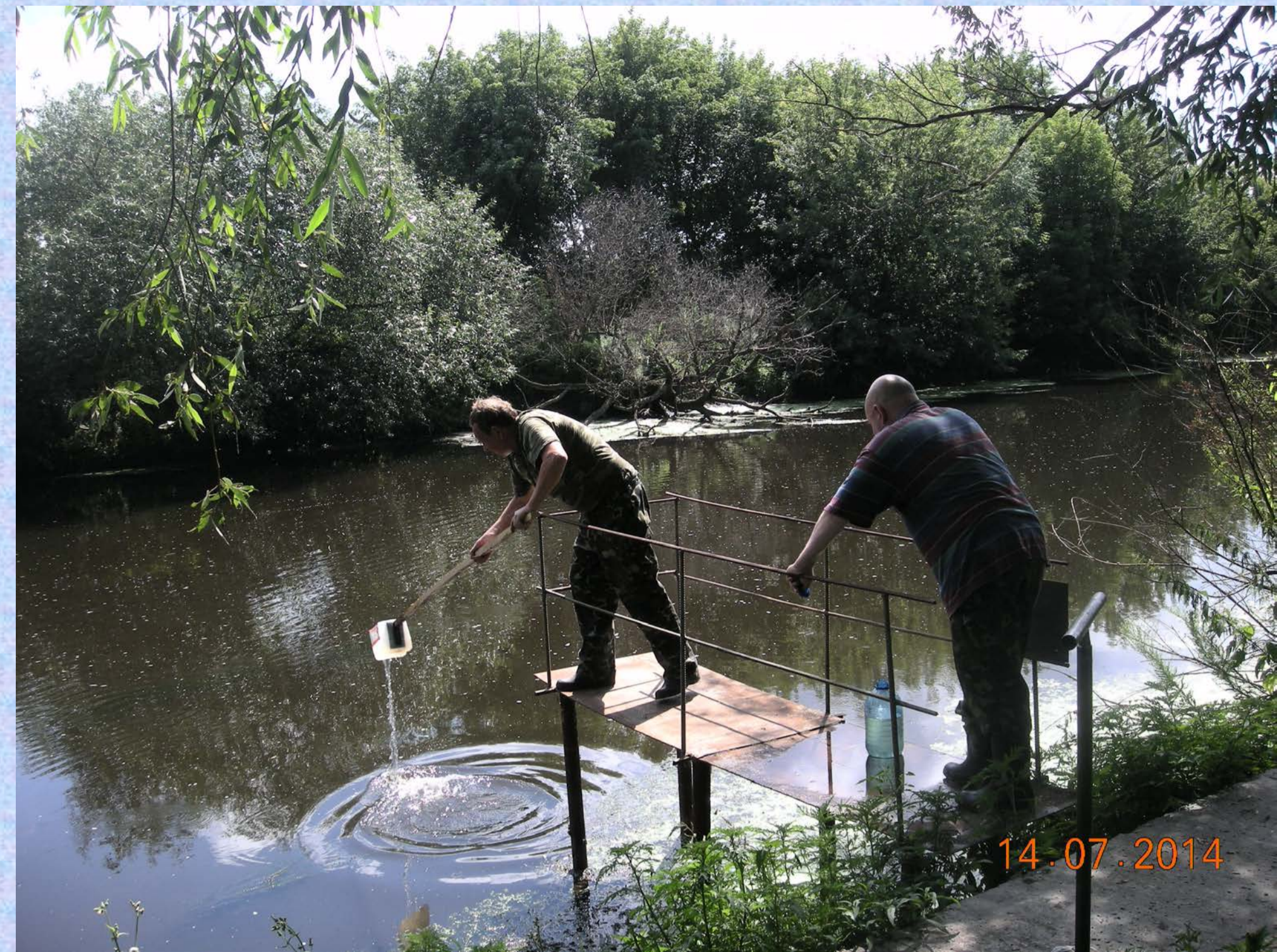
Стационарний пункт режимних спостережень за зворотними водами водовідвідного каналу БСА
